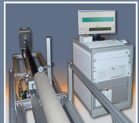
Scan System für zylindrische Bauteile Ø 70-1600mm, Länge bis zu 2270mm
